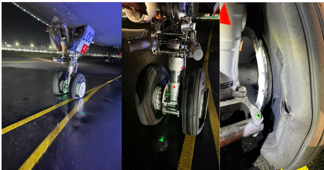
Figura 2 – Avarii produse asupra trenului de aterizare față
